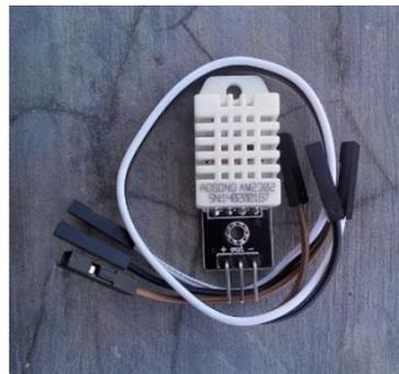
Gambar 2.7 Sensor DHT22
