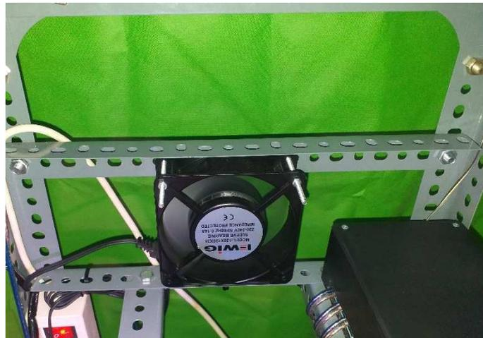
Gambar 5.3 Gambar Peletakan Kipas AC 220
