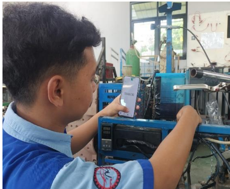
Lampiran 4 Proses menghitung konsumsi bahan bakar.
