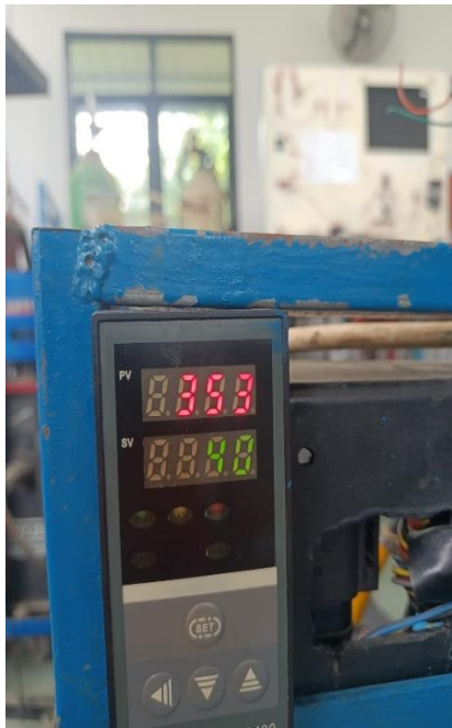
Lampiran 2 Proses menghitung suhu EGT.
