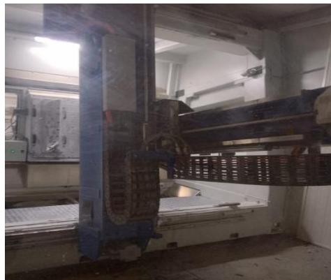
Gambar 2. 9 Rangka mesin CNC
