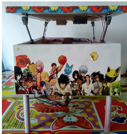
Gambar 5.2. Pemasangan Gas Spring Hidrolik
