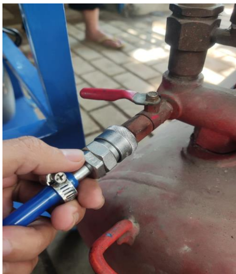
Gambar 3.10 Penyambungan selang ke kompresor besar
