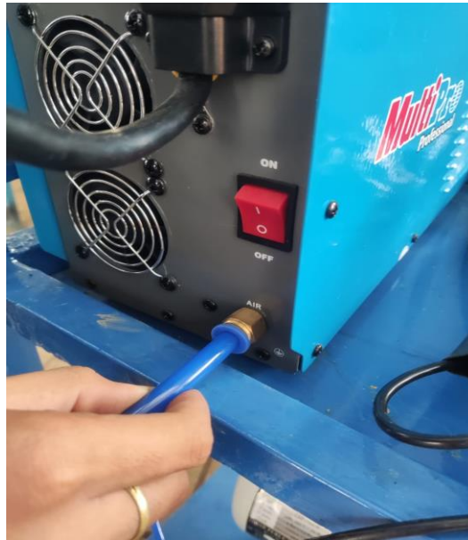
Gambar 3.13 Pasang selang ke mesin
