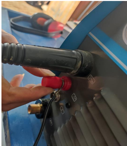
Gambar 3.14 Pemasangan kabel grounding
