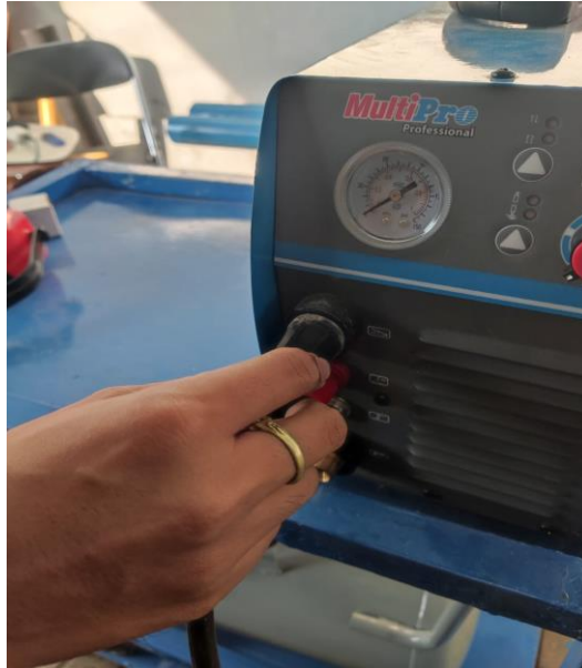
Gambar 3.15 Pemasangan Quick Socket
