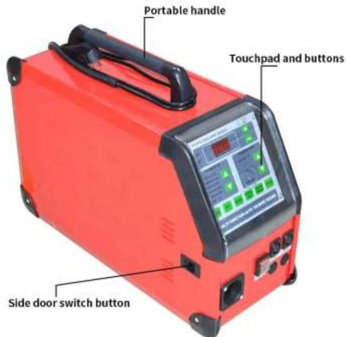
Gambar 2.7 Pengumpan Kawat (*Wire Feeder*)
