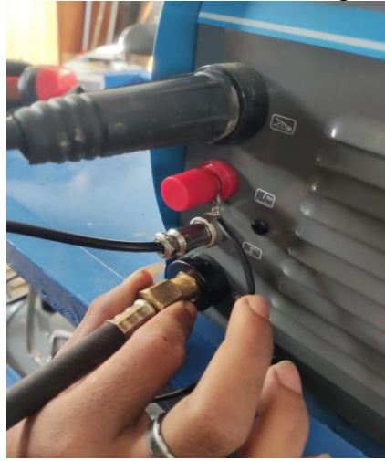
Gambar 3. 20 Pemasangan Kabel gas Electric
