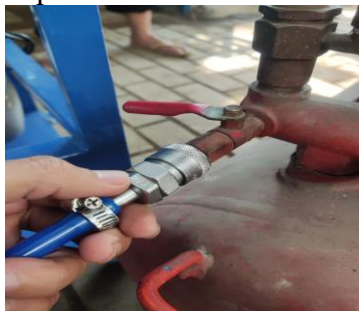
Gambar 3. 13 Penyambungan Selang Kompresor kecil ke Kompresor besar
