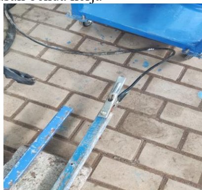
Gambar 3. 19 Menjepitkan Masa Ke Lintasan Benda Kerja
