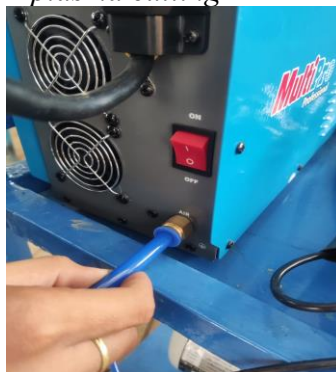
Gambar 3. 16 Pemasangan Selang Ke Mesin Plasma
