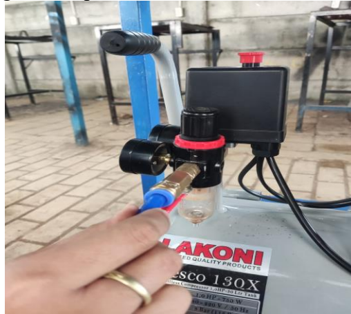
Gambar 3. 14 Penyambungan Selang ke Kompresor Kecil
