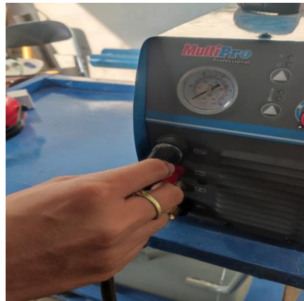
Gambar 3. 18 Pemasangan Quick Socket
