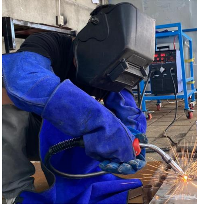
Lampiran 1.1 Proses pengelasan MIG CO2
