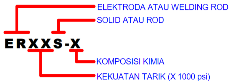
Gambar 2.27 Model penomoran elektroda ferro (Tim Fakultas UNY, 2004)
