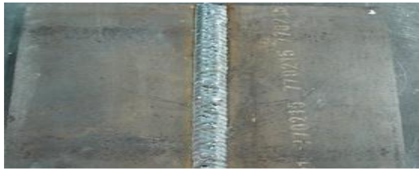
Gambar 2.1 Ciri Pengelasan Yang Bagus (Jody, 2019)
