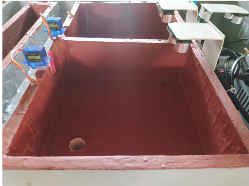
Gambar 5. 2 Prototype alat sistem kontrol ketinggian air pada sawah
