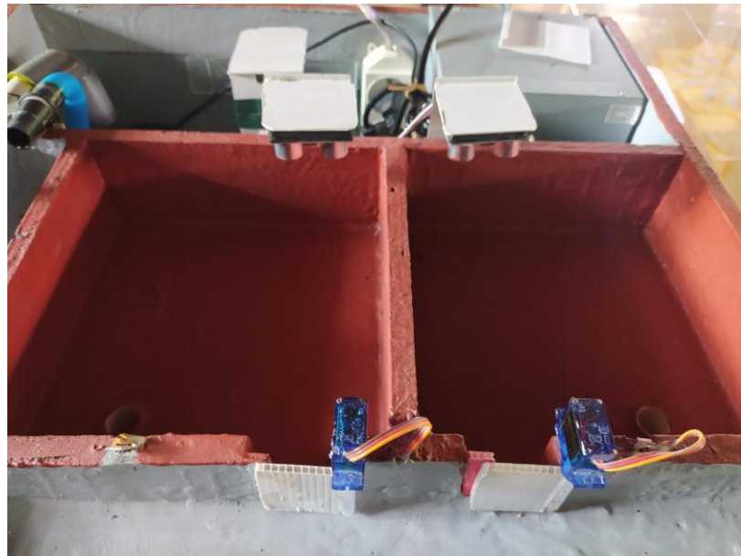
Gambar 5. 1 Prototype alat sistem kontrol ketinggian air pada sawah
