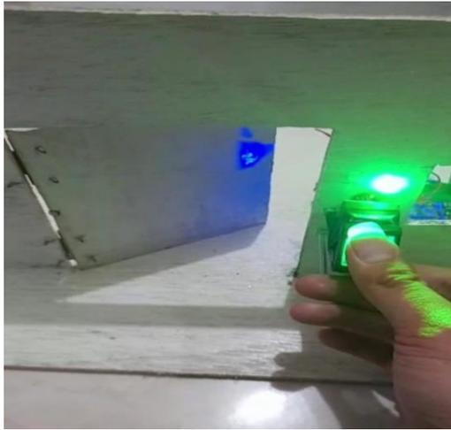
Gambar 4. LED Hijau pengujian fingerprint berhasil
