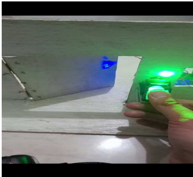
Gambar 5.2 LED hijau pengujian fingerprint berhasil
