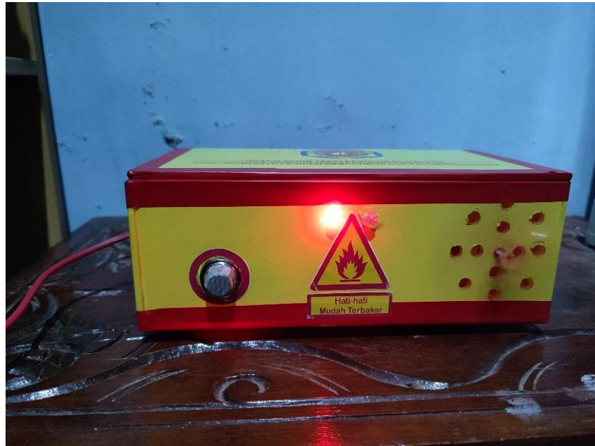
Gambar 5.2 Alat menyala saat kepekatan gas lebih dari 200 ppm
