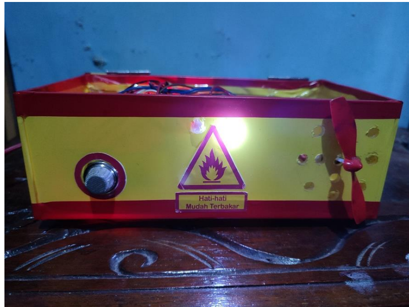
Gambar 5.1 Alat menyala saat kepekatan gas kurang dari 200 ppm
