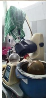
Proses penguapan ekstrak menggunakan evaporator
