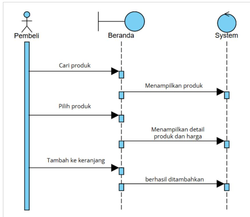
Gambar 4. 14 Sequence Diagram Tambah Barang ke Keranjang
