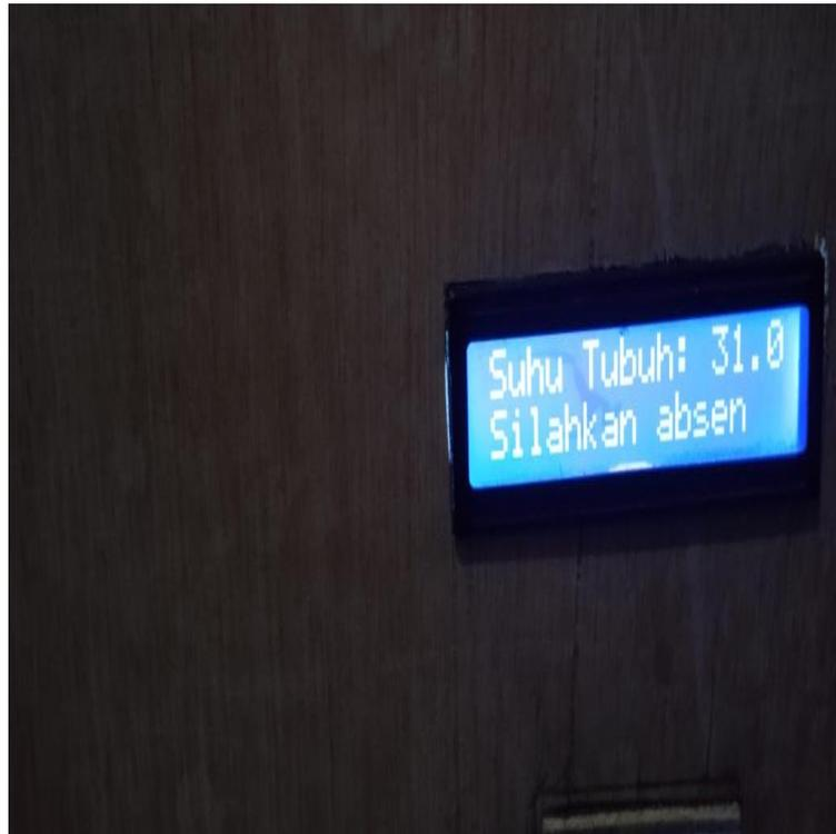
Gambar 5.5 Hasil pembacaan sensor suhu tampil pada LCD
