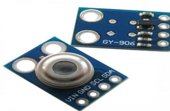
Gambar 2.8 Sensor Suhu Inframerah MLX90614
