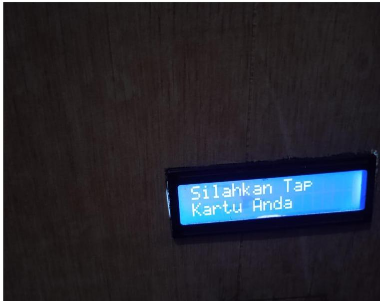
Gambar 5.6 Tampilan LCD saat akan menempelkan kartu RFID
