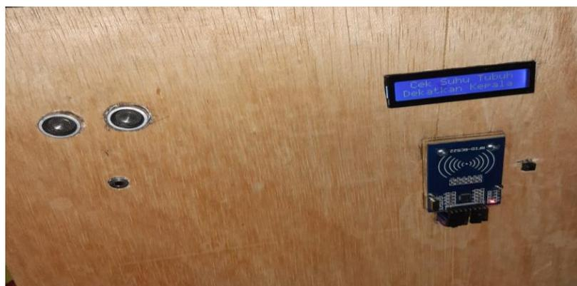
Gambar 5.4 Tampilan sensor Ultrasonik dan sensor suhu MLX90614
