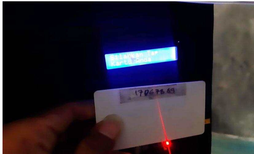
Gambar 5.8 Tap Kartu pada sensor RFID
