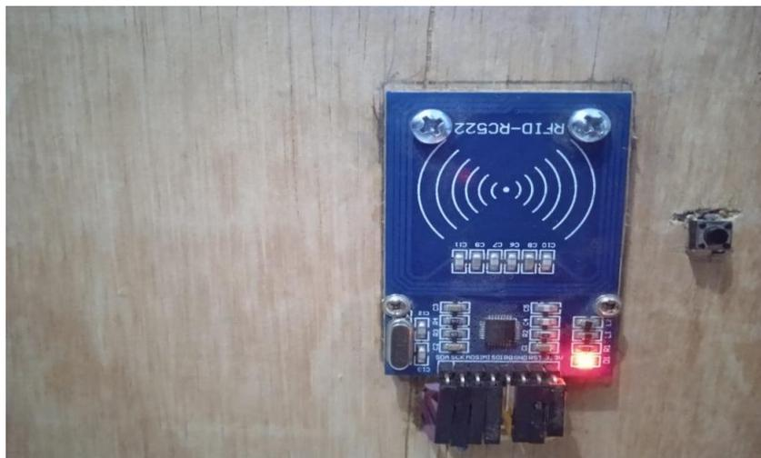
Gambar 5.7 Tampilan sensor RFID
