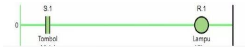
Gambar 2. 40 NO saat program berjalan dan dengan logika “true”
