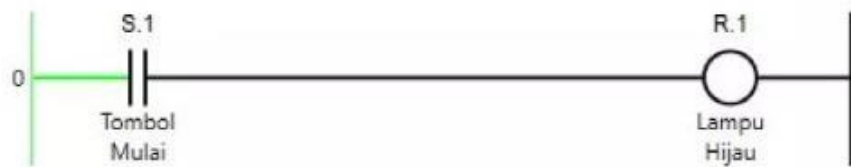
Gambar 2. 39 NO saat program berjalan dan dengan logika “false”
