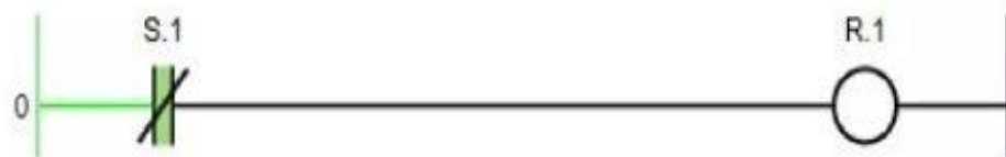
Gambar 2. 42 NC saat program berjalan dan dengan logika “false”
