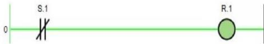
Gambar 2. 43 NC saat program berjalan dan dengan logika “true”
