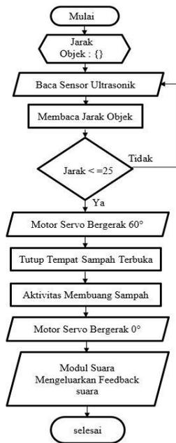
Gambar 2. *Flowchart* Membuka dan Menutup Tutup Tempat Sampah Otomatis
