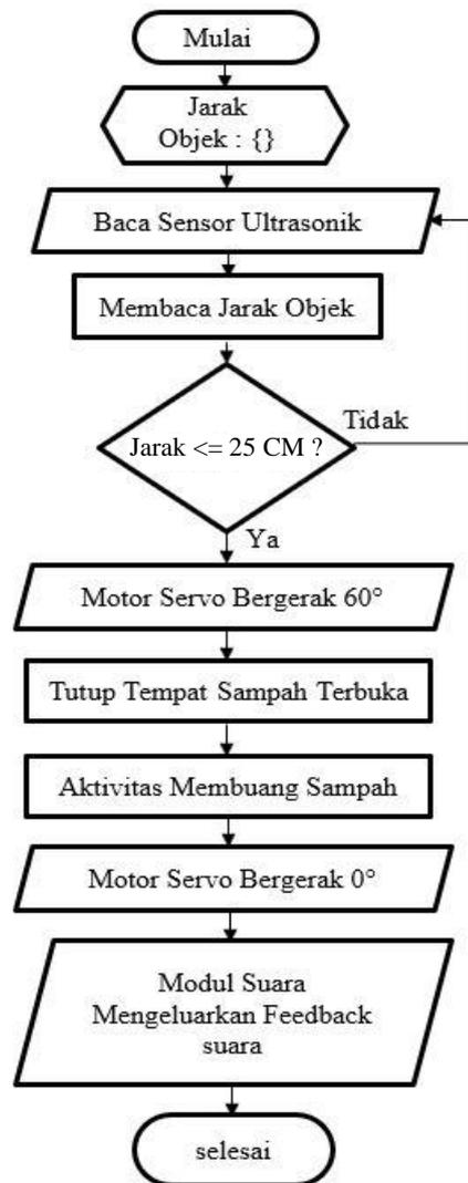
Gambar 4.2 *Flowchart* Membuka dan Menutup Tutup Tempat Sampah Otomatis
