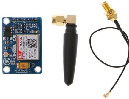
Gambar 2.9 Modul GSM SIM800
