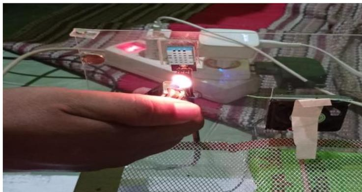
Gambar 5. 6 Pengujian sensor DHT11 menggunakan Api
