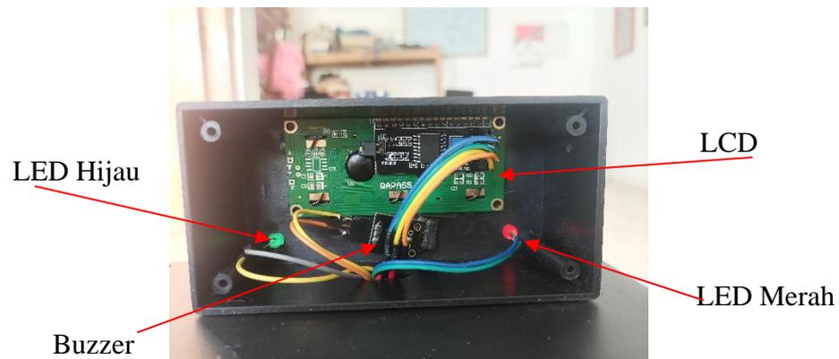
Gambar 0.2 *LCD, LED, dan Buzzer*
