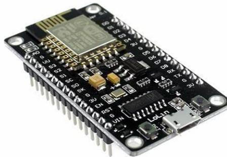
Gambar 0.6 *NodeMcu Esp 8266*
