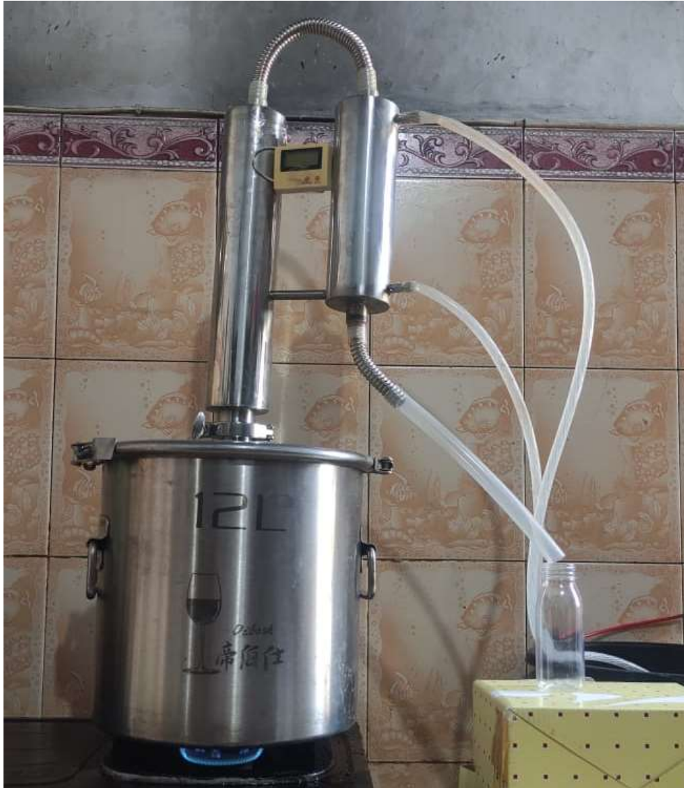
Lampiran 1 Proses destilasi menggunakan panci destilasi
