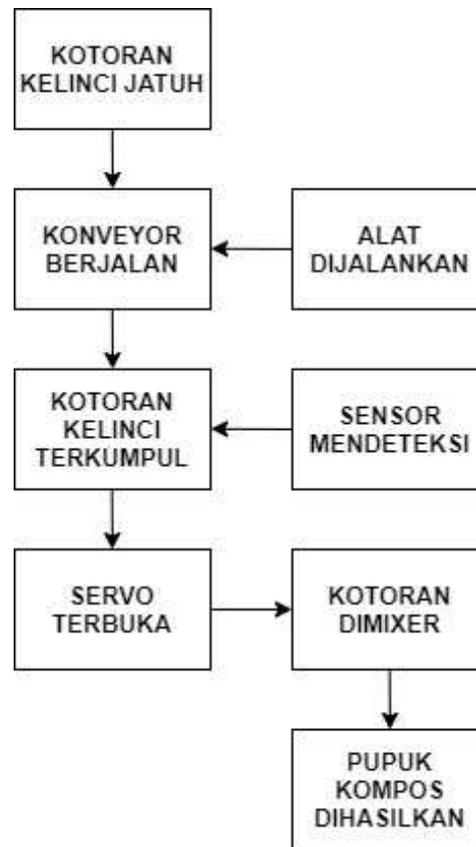
Gambar 4. 1 Diagram Blok Alat
