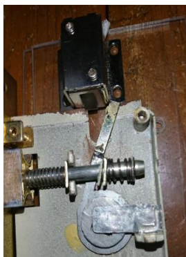
Gambar 2 Kunci Solenoid Terbuka
