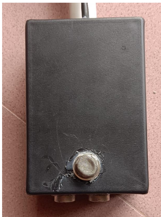
Gambar 5. 3 Box Sensor tampak depan alat ketinggian volume septik tank dan netralisasi kadar gas
