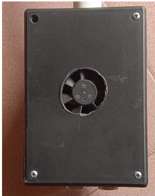
Gambar 5. 4 Box Sensor tampak belakang alat ketinggian volume septik tank dan netralisasi kadar gas
