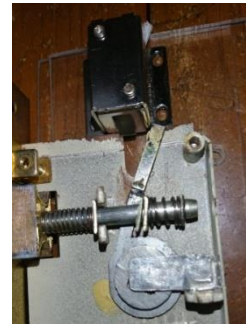
Gambar 6 Solenoid Door Lock Membuka Pengunci
