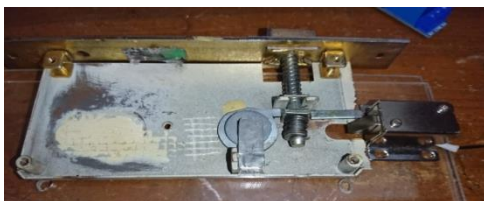
Gambar 5 Solenoid Door Lock Mengunci
