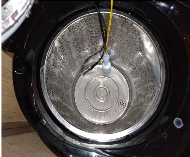
Gambar 5.7 Sensor Suhu DS18B20 dan *Water Level Float Sensor Switch*
