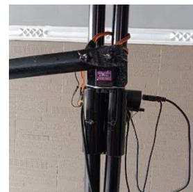
Gambar 4. *Motor Servo yang Terhubung Dengan Raspberry pi 4*
