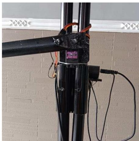
Gambar 5. 1 Servo yang di Hubungkan Dengan Raspeberry Pi 4
