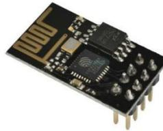
Gambar 2.2. *Module Wi-Fi ESP8266*
