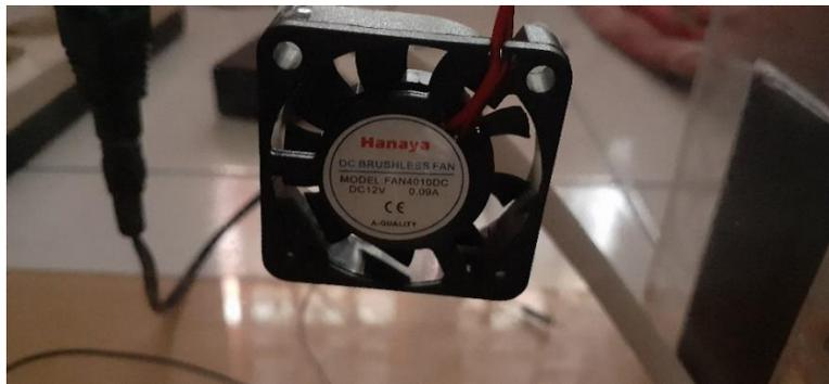
Gambar 5.7. Hasil Pengujian Kipas Mati
