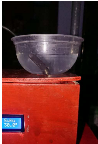
Gambar 8 Hasil Pengujian Sensor suhu pada air biasa
