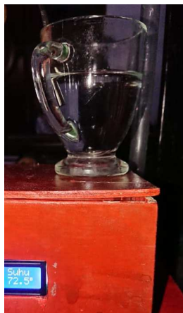
Gambar 9 Hasil Pengujian Sensor suhu pada air panas
