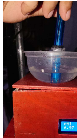
Gambar 5 Hasil Pengujian Sensor pH 4502C pada air sumur
