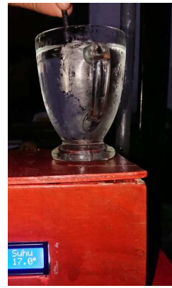
Gambar 10 Hasil Pengujian Sensor suhu pada air es
