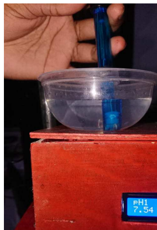
Gambar 6 Hasil Pengujian Sensor pH 4502C pada air aqua
