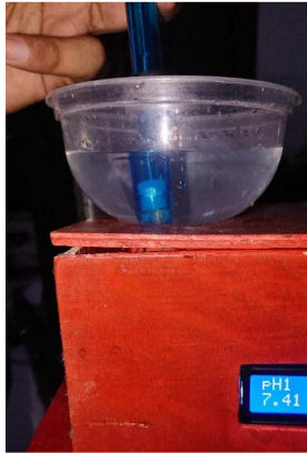
Gambar 7 Hasil Pengujian Sensor pH 4502C pada air pdam
