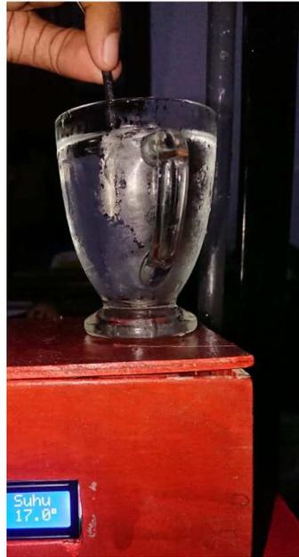
Gambar 5.6. Hasil Pengujian Sensor suhu pada air es
