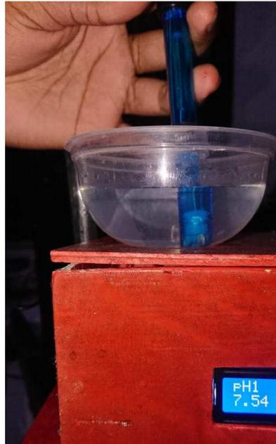
Gambar 5.2. Hasil Pengujian Sensor pH 4502C pada air aqua
