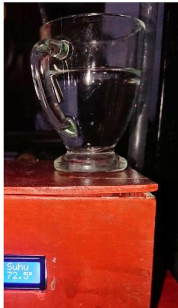
Gambar 5.5. Hasil Pengujian Sensor suhu pada air panas
