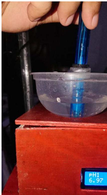
Gambar 5.1. Hasil Pengujian Sensor pH 4502C pada air sumur
