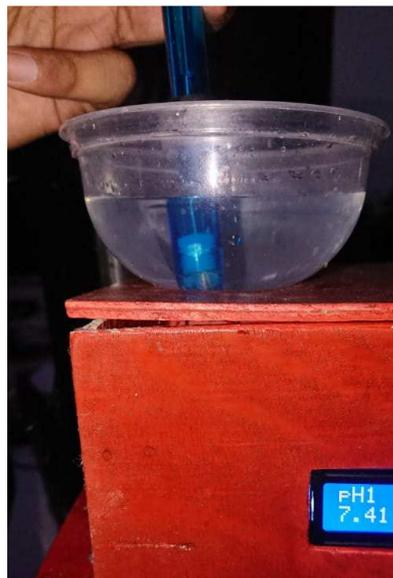
Gambar 5.3. Hasil Pengujian Sensor pH 4502C pada air pdam
