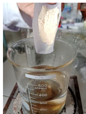
Larutkan serbuk MHA kedalam 300 ml aquadest lalu dipanaskan, aduk hingga mendidih dan homogen
