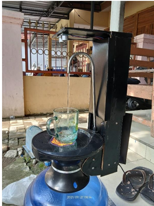
Gambar 5. 9 Tampilan waterpump dan relay on air keluar
