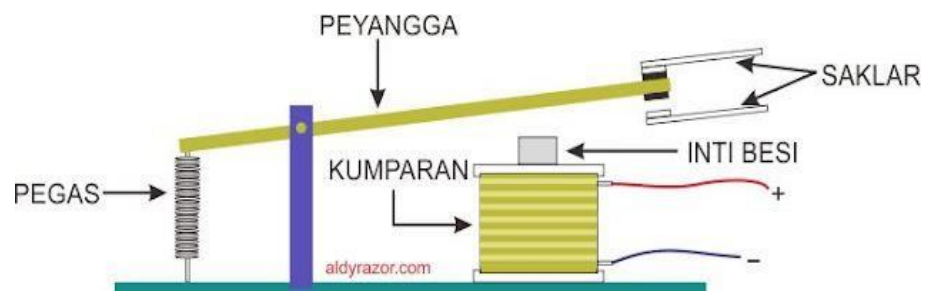
Gambar 2.2 Cara Kerja Relay 5 volt
