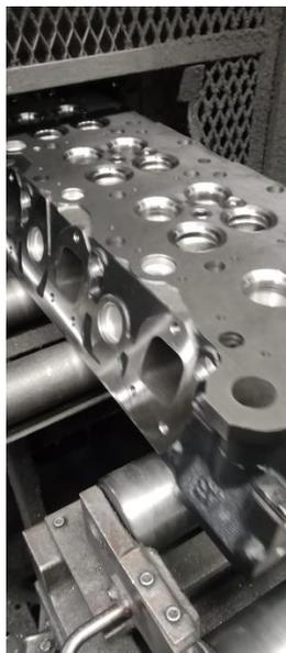
Gambar 4.10 Pemberian inisial pada cylinder bore head
