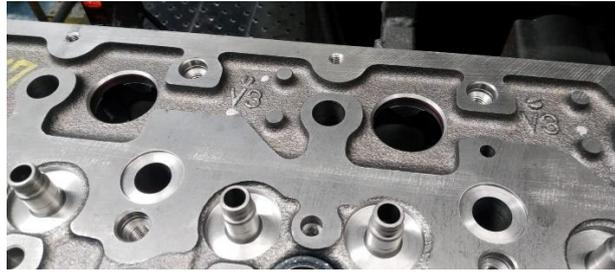
Gambar 4.5 Lubang Cylinder Head sebelum dipasang dudukan
