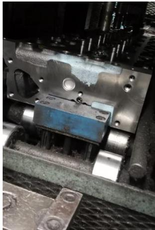
Gambar 4.4 Pemasangan Head Bolt oleh robot
