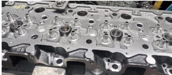
Gambar 4.3 Pemasangan Head Bolt ke lubangnya
