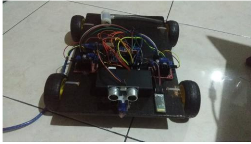
Gambar 6 Rangkaian komponen pada prototype bagian sensor
