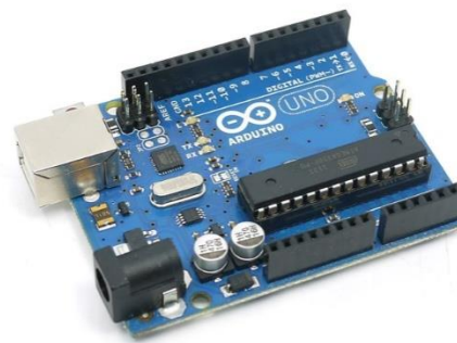
Gambar 2.1 Arduino Uno R3
