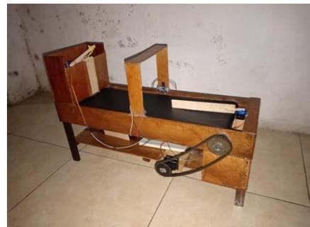
Gambar 4. Alat Penyortiran Kacang Tanah
