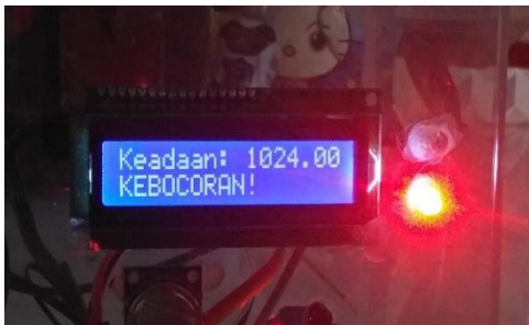
Gambar 5. kondisi kebocoran gas
