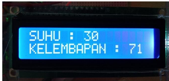
Gambar 5. 14 Tampilan Suhu dan Kelembaban di LCD
