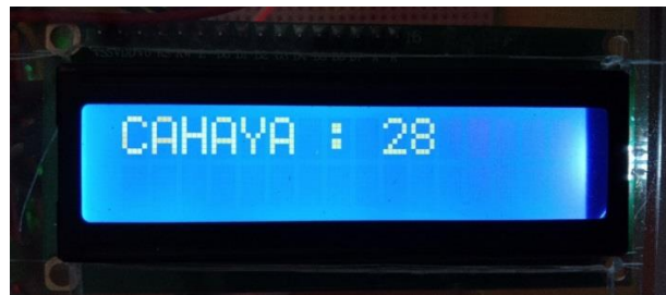
Gambar 5. 15 Tampilan intensitas cahaya di LCD
