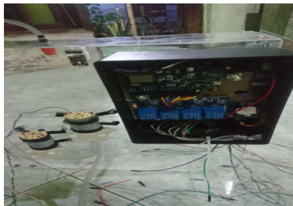
Gambar 5.3 Sensor soil , DHT 22 pada Prototype
