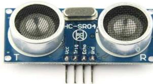
Gambar 2. 4 *Sensor Ultrasonik*
