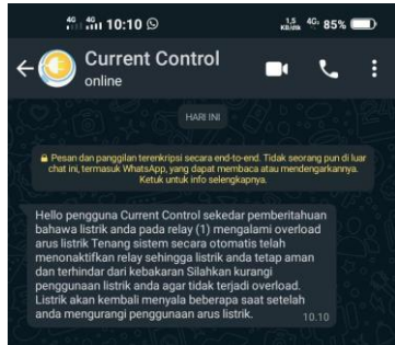
Gambar 3 Notifikasi WhatsApp Adapun hasil dari notifikasi tersebut adalah “Hello pengguna Current Control sekedar pemberitahuan bahwa listrik pada relay (1) mengalami overload arus listrik. Tenang, sistem secara otomatis telah menonaktifkan relay sehingga listrik anda tetap aman dan terhindar dari kebakaran. Silahkan kurangi penggunaan listrik anda agar tidak terjadi overload. Listrik akan kembali menyala beberapa saat setelah anda mengurangi penggunaan arus listrik.”
