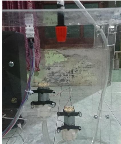
Gambar 5.4 sensor *soil*, DHT 22 pada *Prototype*
