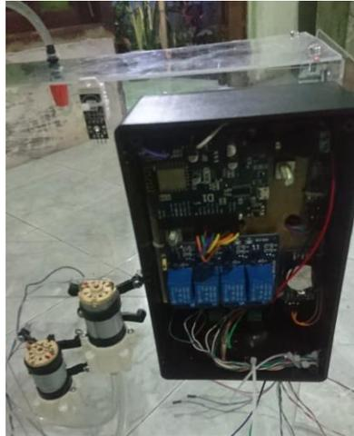
Tampilan rancang bangun *smart* sawah, dalam gambar terlihat sensor DHT22, spuyer, 2 buah pompa serta *black box* yang berisi *wemos* sebagai pemroses data, *relay* pengatur saklar pompa dan *RTC module* sebagai jadwal pemupukan bawang merah.
