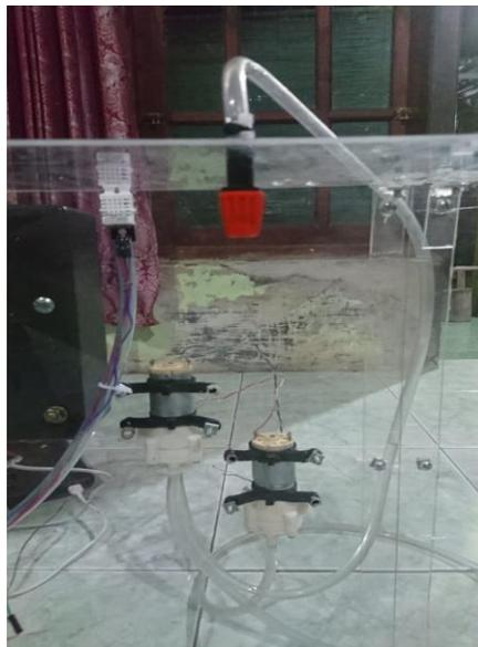
Tampilan sensor *DHT 22* sebagai pendeteksi suhu ruangan dan *spuyer* sebagai pengkabutan partikel air sehingga penyiraman terjadi secara merata. Dan pompa untuk pengendalian aliran air untuk penyemprotan dan pemupukan.
