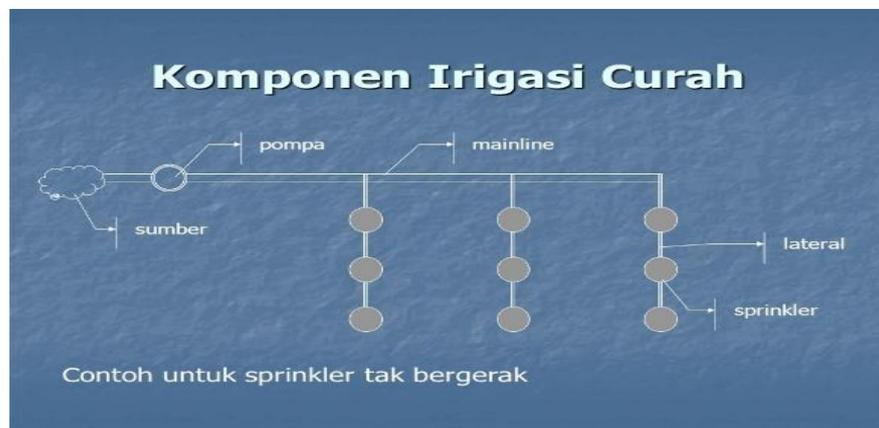
Gambar 2.1 Sistem Irigasi Curah/ *Sprinkler*
