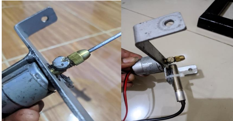
Gambar 4.18 Proses pemasangan sensor dan magnet rpm
