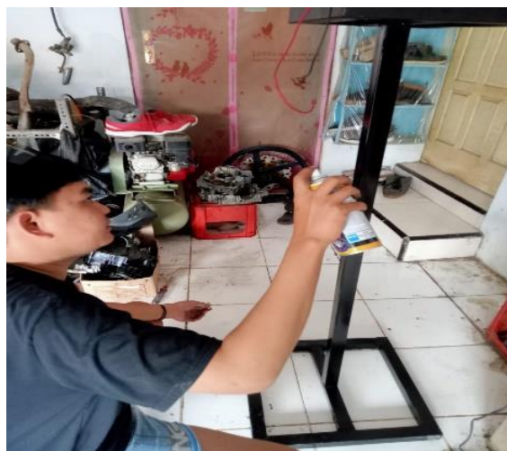
Gambar 4.9 Proses pengecatan rangka
