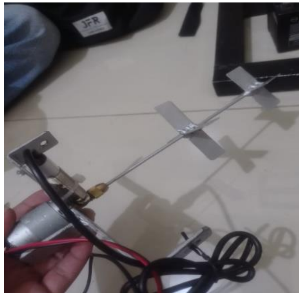
Gambar 4.19 Proses pemasangan baling baling
