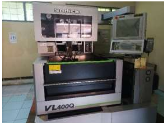
Gambar 4.6 pemotongan baja dengan mesin wire cut
