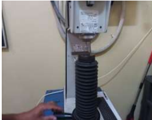
Gambar 4.9 Proses penitikan baja HSS
